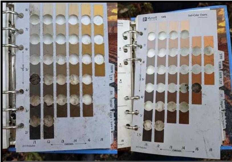
Figure 79. Couleur Munsell de la matrice (à gauche) et des mouchetures (à droite). MH-8, le 29 août 2021, sur le lot 5 583 612.
