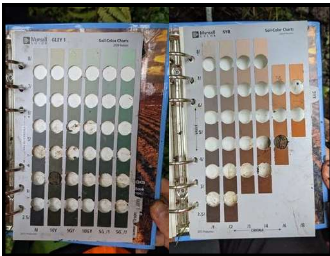
Figure 83. Couleur Munsell de la matrice (à gauche) et des mouchetures (à droite). Le 30 août 2021 sur le lot 5 583 612.
