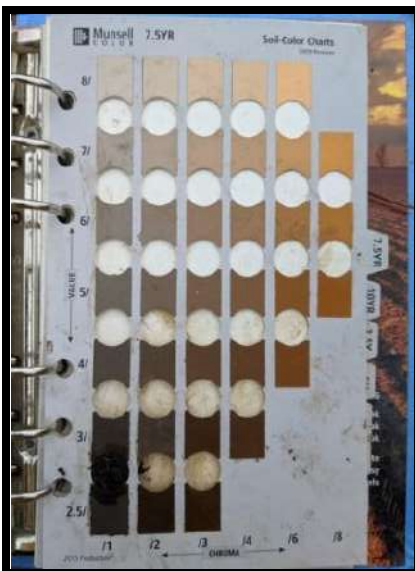
Figure 102. Couleur Munsell du sol hydromorphe. MH-12B, 1er octobre 2021 sur le lot 5 583 612.
