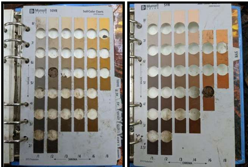
Figure 91. Couleur Munsell de la matrice (à gauche) et des mouchetures (à droite). MH-11A, 1er octobre 2021 sur le lot 5 583 612
