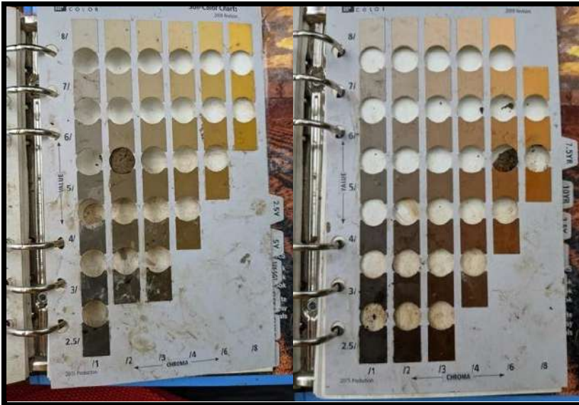
Figure 76. Couleur Munsell de la matrice (à gauche) et des mouchetures (à droite). MH-7C, le 29 août 2021, sur le lot 5 583 612.
