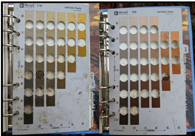
Figure 113. Couleur Munsell de la matrice (à gauche) et des mouchetures (au centre) du sol à 30 cm (à droite) situé sur le MH-16, 14 octobre 2021 sur le lot 5 583 612.
